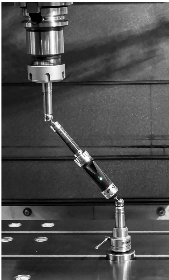
使用雷尼绍XR20-W搭配XL-80激光干涉仪进行出厂前检测
