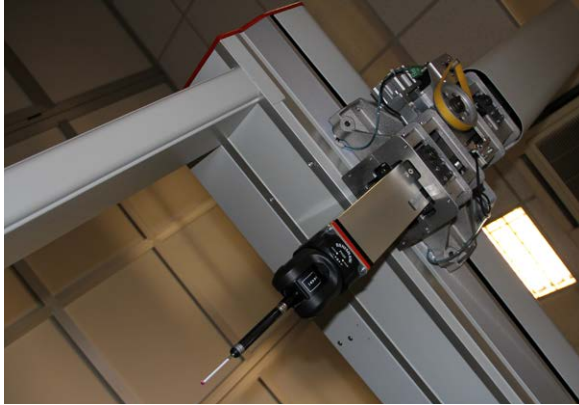
在COORD-3坐标测量机上安装PH20测座以执行五轴测量
