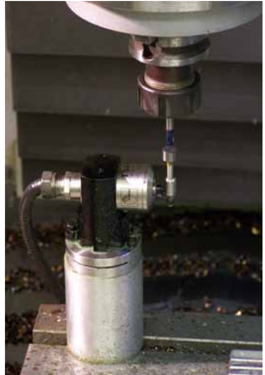
快速准确的机内对刀不仅提供一致的结果，还考虑到热膨胀效应
